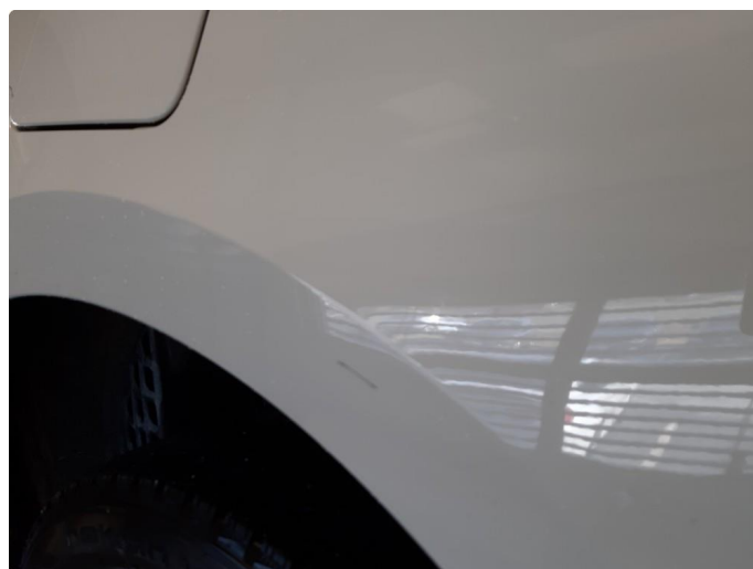
2.3 Ripe(r) ned til grunning
