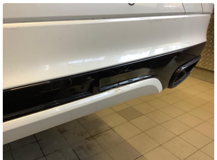
1.4 Liten skrape/skrubb nedre del av fangerdeksel
