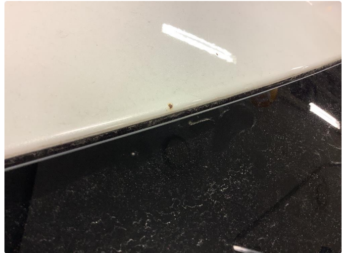
1.2 Steinsprut med rust
