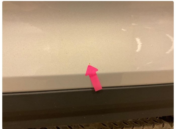
1.2 Steinsprut med rust
