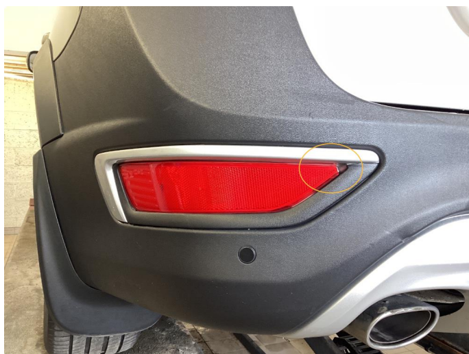
2.2 Tåkelys - defekt/sprukket glass
