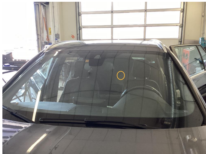
1.2 Steinsprut med sprekk
