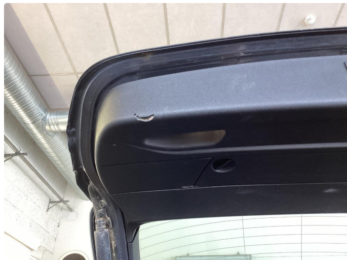
2.1 Skadet/merker etter utstyr
