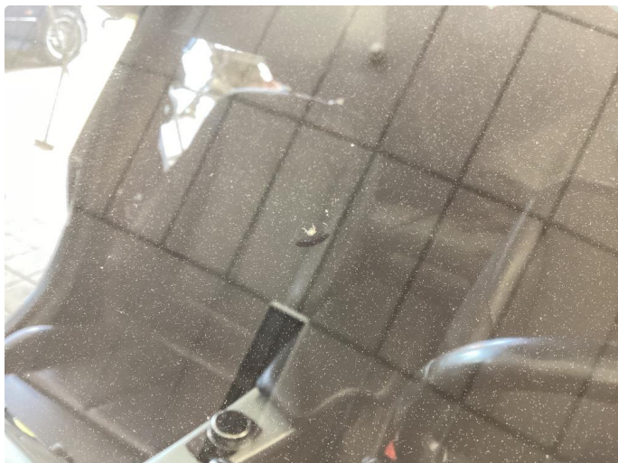
1.2 Steinsprut med sprekk
