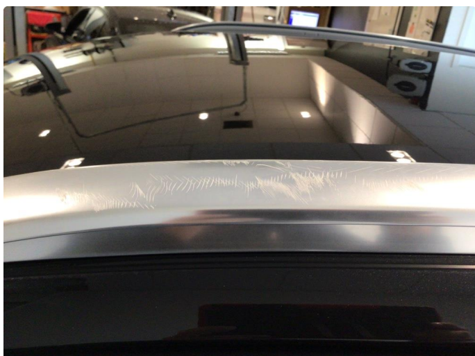
1.2 Bruksmerker A-stolpe og takrails venstre side
