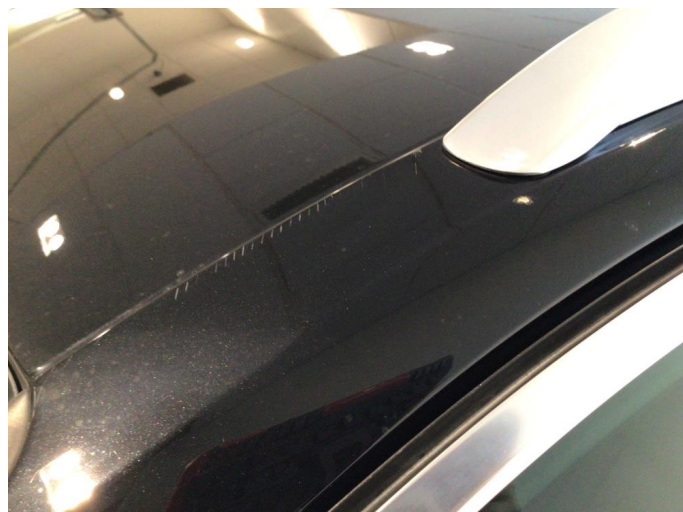
1.2 Bruksmerker A-stolpe og takrails venstre side
