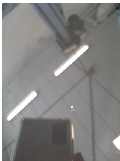
1.6 Steinsprut med sprekk
